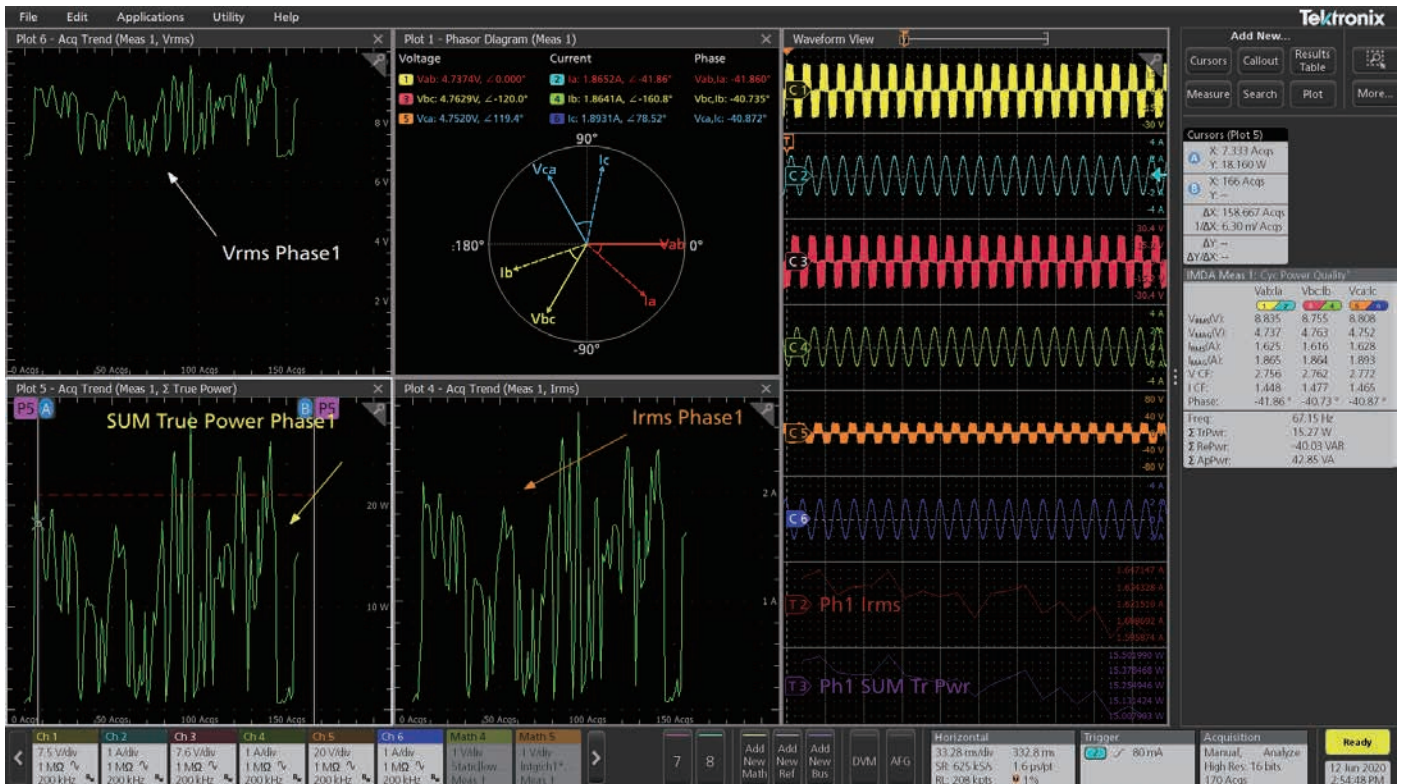
図42. アクイジション・トレンド・プロットによる、複数のアクイジションにおける測定値変化の記録例。グリーン色の波形で表示されており、直近のアクイジションにおける波形と測定値も表示されている
