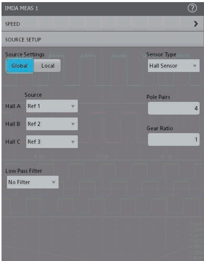
図36. ホール素子を使用したシステムの、オシロスコープによる回転速度測定の設定
