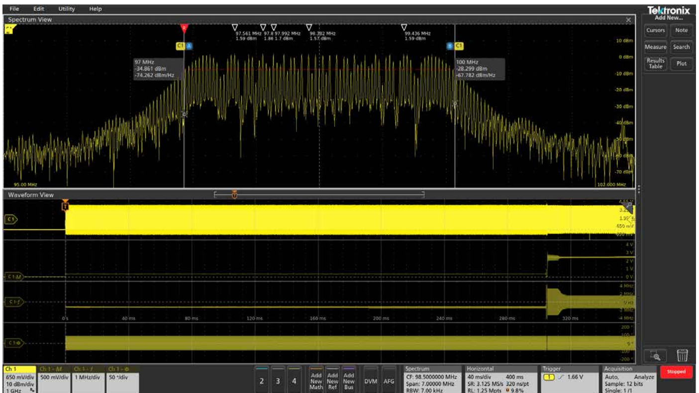
図10. 振幅対時間波形、周波数対時間波形により、この拡散スペクトラム・クロックの変化の様子が容易に観測できる。振幅対時間波形では、非常の小さなレベルのトリガ・ポイントで信号がオンになっている様子が、周波数対時間波形では最初の約300ms、一定の周波数にとどまっている様子がわかる。このポイントにおいて、信号の振幅が大きくなり、周波数に変化しだしていることがわかる。
