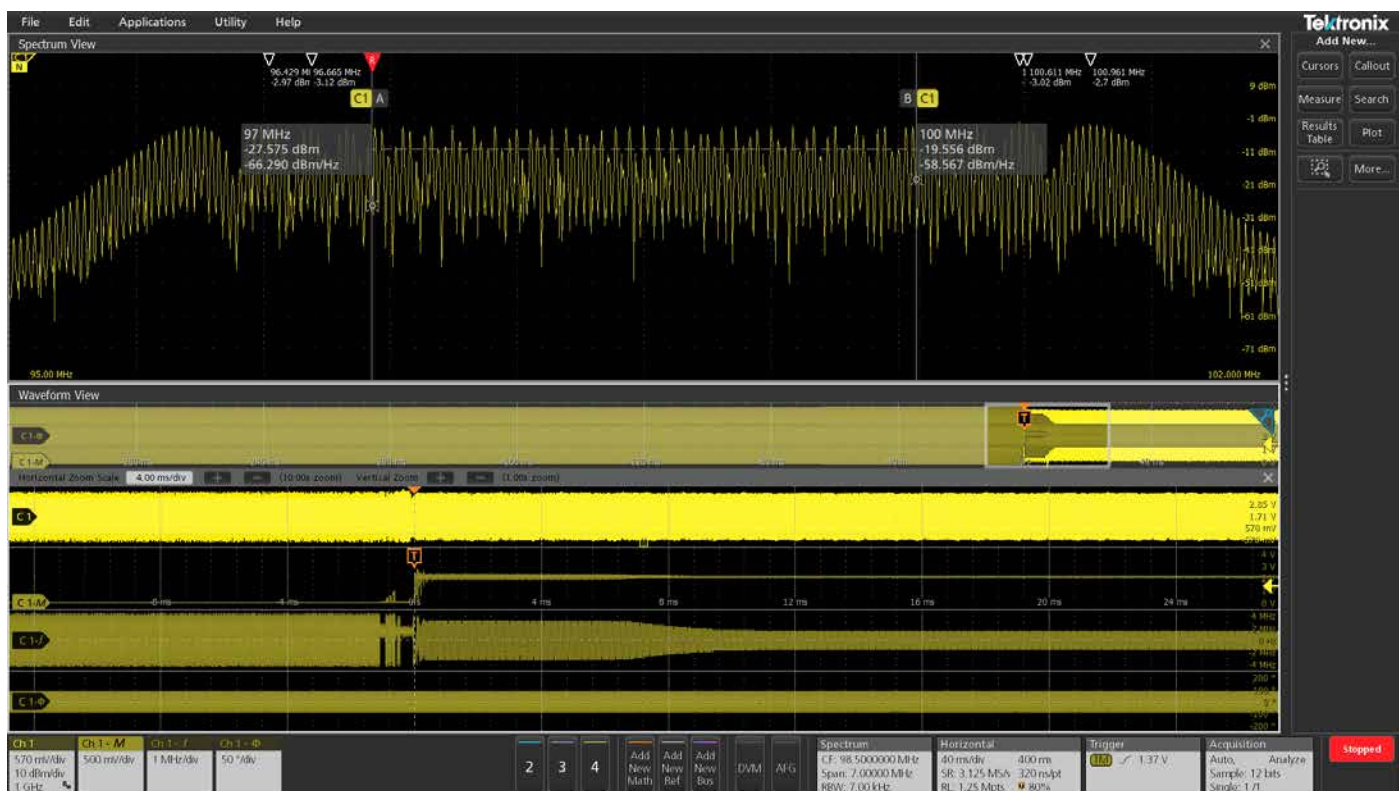
図13. クロックオン時の変化にフォーカスする場合は、トリガソースをRF振幅対時間波形に設定することで行えます。(注: この測定は、図10~12よりも新しいファームウェアで実施しています。)
