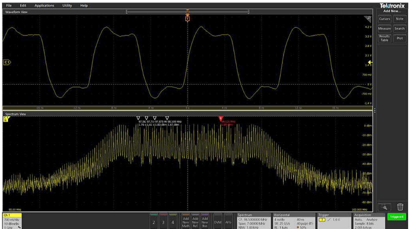
図5. 図3、図4で観測したのと同じスペクトラム拡散クロック信号。Spectrum Viewでは、時間ドメインと周波数ドメインの両方を同時に、最適に表示できる。
