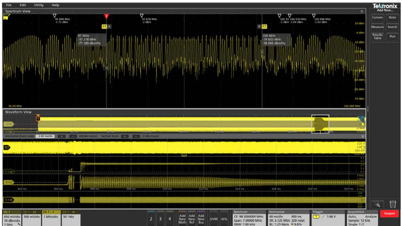
図11. 特定の期間でズーム表示している(トリガ・ポイント後の約300~320ms)。振幅が変動し、本来よりも広い範囲で周波数が変化している様子がわかる。
